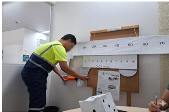
Figura 8 - Aplicação do Paquímetro Pedagógico
