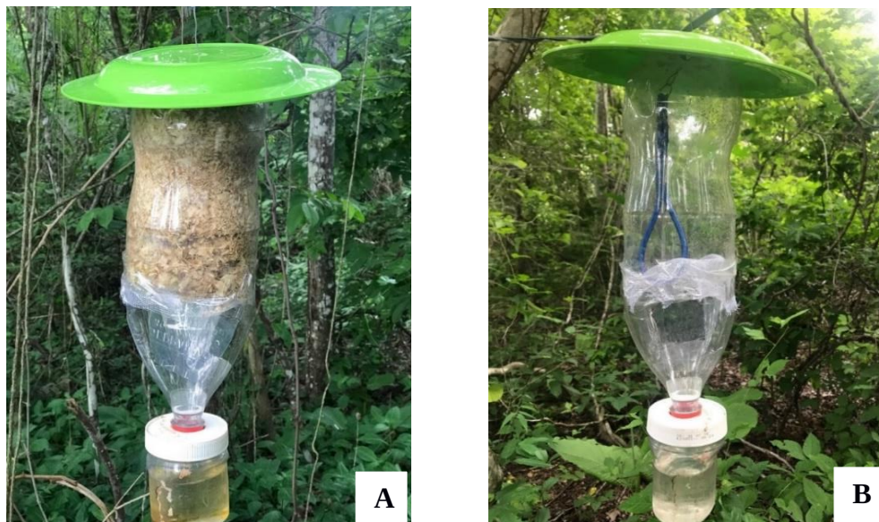
Figura 2 – Armadilha de impacto modelo Bionorte, confeccionada a partir de materiais recicláveis, instalada em fragmento de Cerrado, Palmas-TO, 2016. (A) Uso de serragem como atrativo; (B) Uso de etanol como atrativo.
