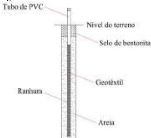
Figura 4 - Detalhes construtivos do medidor do nível freático.
